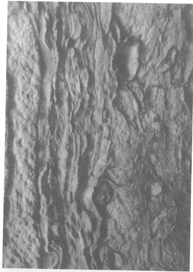
Fot. 4 - Poloha pískovce, bohatá na příčné průřezy železitých „trubek“ různých velikostí. V horní části snímku je patrné rozdílné zvětrávání poloh pískovce.
